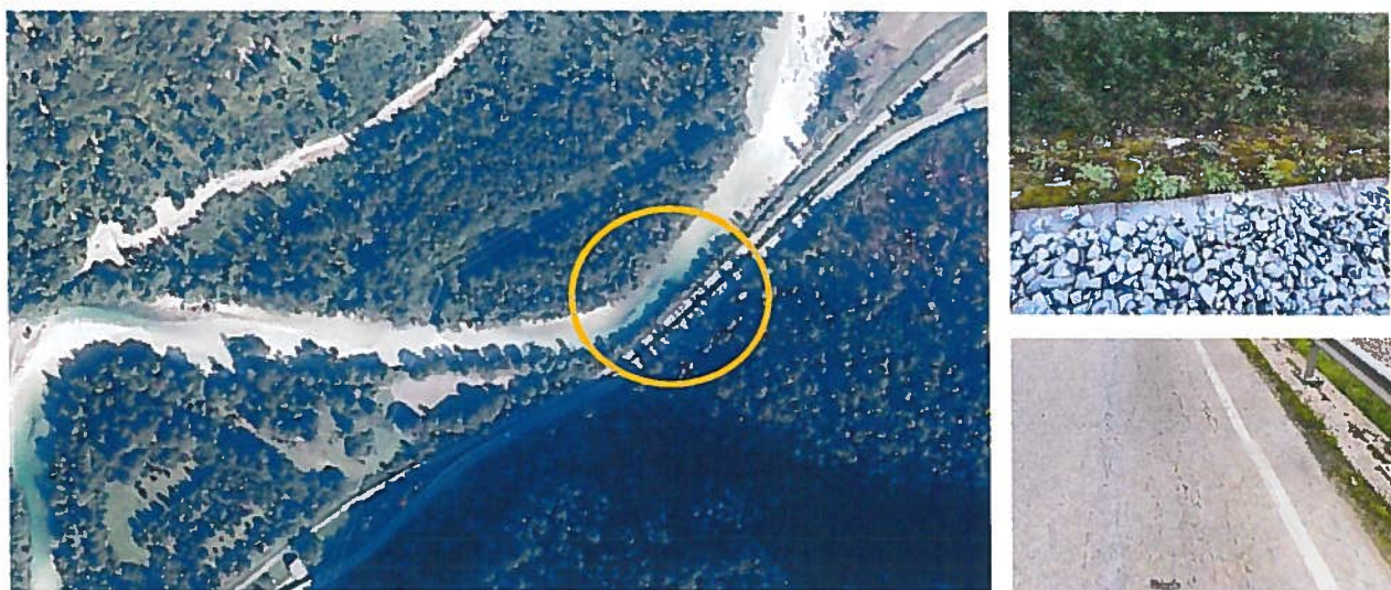
Slike 3, 4 in 5: Potek Save Bohinjke, železnice in ceste (leva slika); Obstoječe stanje objekta PZ 2-12 – poraščena obloga, tolčenec lahko pada v strugo (desno zgoraj slika); Detajl stanja ceste in betonskega zidu pod cesto in nad progo (desno spodaj slika)
